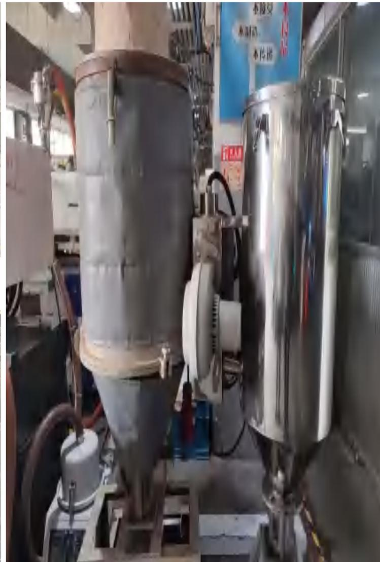
注塑机干燥料斗采用热风回收节能器
